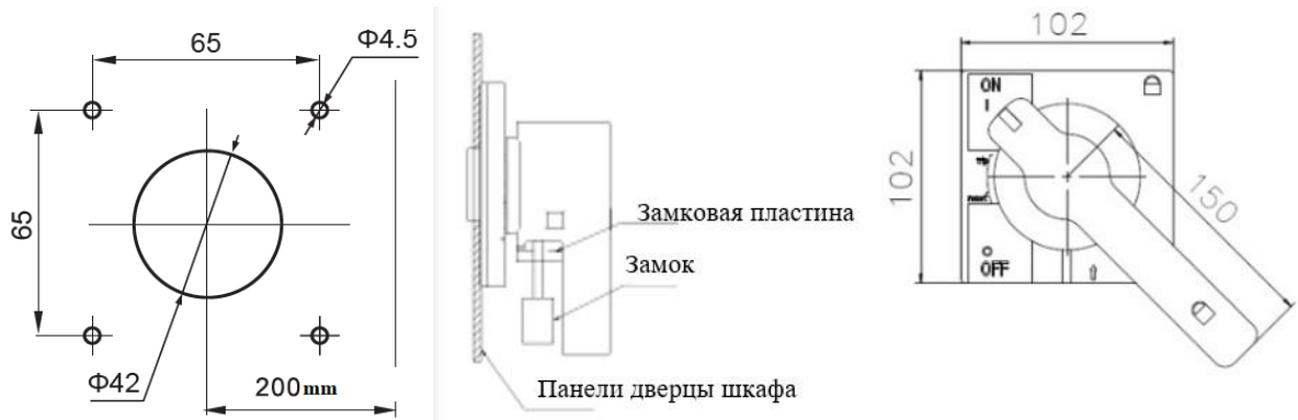
Габаритные и установочные размеры рукоятки оперирования, мм
