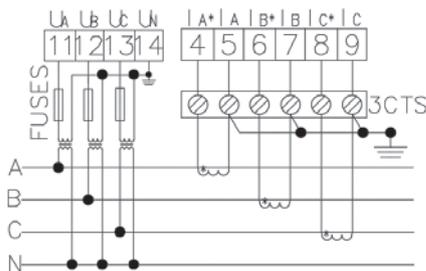
Подключение цепей тока и напряжение (через трансформатор тока – выше 5А, через трансформатор напряжения – выше 600 В)
