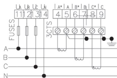
Подключение цепей тока и напряжение (через трансформатор тока – выше 5А, прямое – до 600 В)
