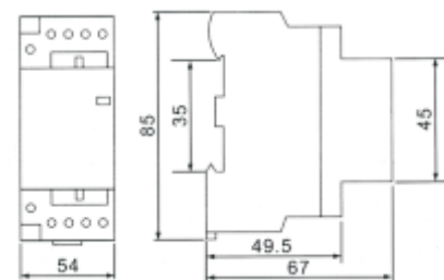
Рис. 3 Внешний вид контакторов МК-103 32-63А (04, 31, 22, 40)
