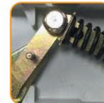
**Пружинный механизм расцепления** обеспечивает быстрое размыкание, предотвращая сваривание контактов и увеличивая коммутационную износостойкость
