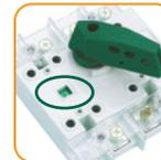
**Наличие окошка индикации** даже при отсутствии видимого разрыва позволяет видеть реальное положение контактов
