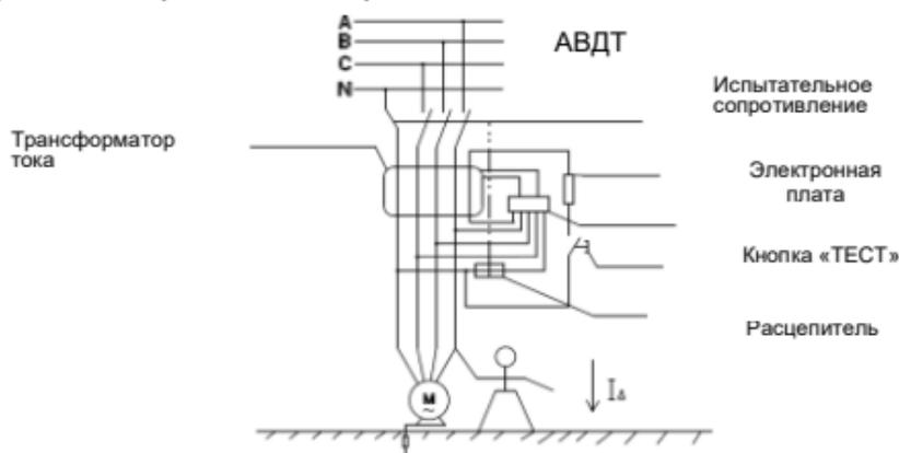
В) Рис. 2 Аппарат 3P+N: четыре проводника.
