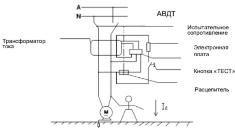
А) Рис. 1 Аппарат 1P+N: два проводника.
